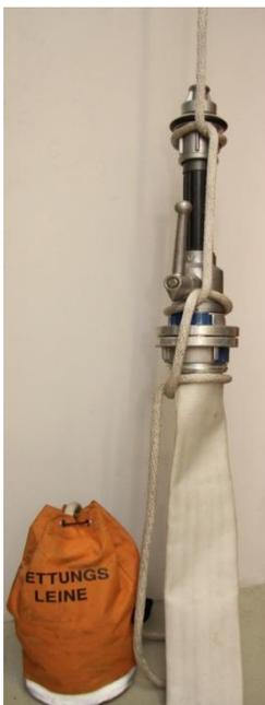
Variante mit Mehrzweck-Strahlrohr
