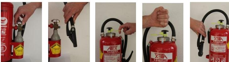
Handrad ganz aufdrehen und Löschpistole drücken. Oder Sicherungsstift ziehen, auf den Schlagknopf drücken und die Löschpistole betätigen.
